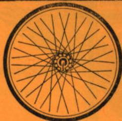
Hätten Sie ihm das zugetraut? Ihm — dem kleinen, dünnen Schlauchreifen! Aber es stimmt tatsächlich. Schlauchreifen werden zur Erzielung eines leichten Laufes mit ca. 8 atü Luftdruck gefahren. Da sich der Druck beim Fahren durch Erwärmung noch um ein bis eineinhalb atü erhöhen kann, ist der Reifen von innen her oft mit 8 bis 15 t belastet
